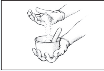
Figura 4 Mezcle pequeñas cantidades del relleno hasta obtener la consistencia deseada.
