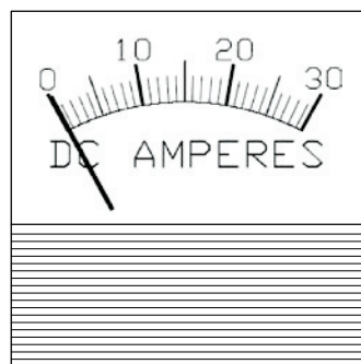
Fig. 16 Ammeter (Amp Meter)
